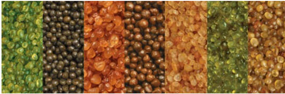
Différents agents de soutènement (proppants en anglais)
