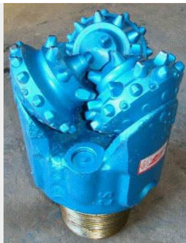
Un trépan ou tricône
